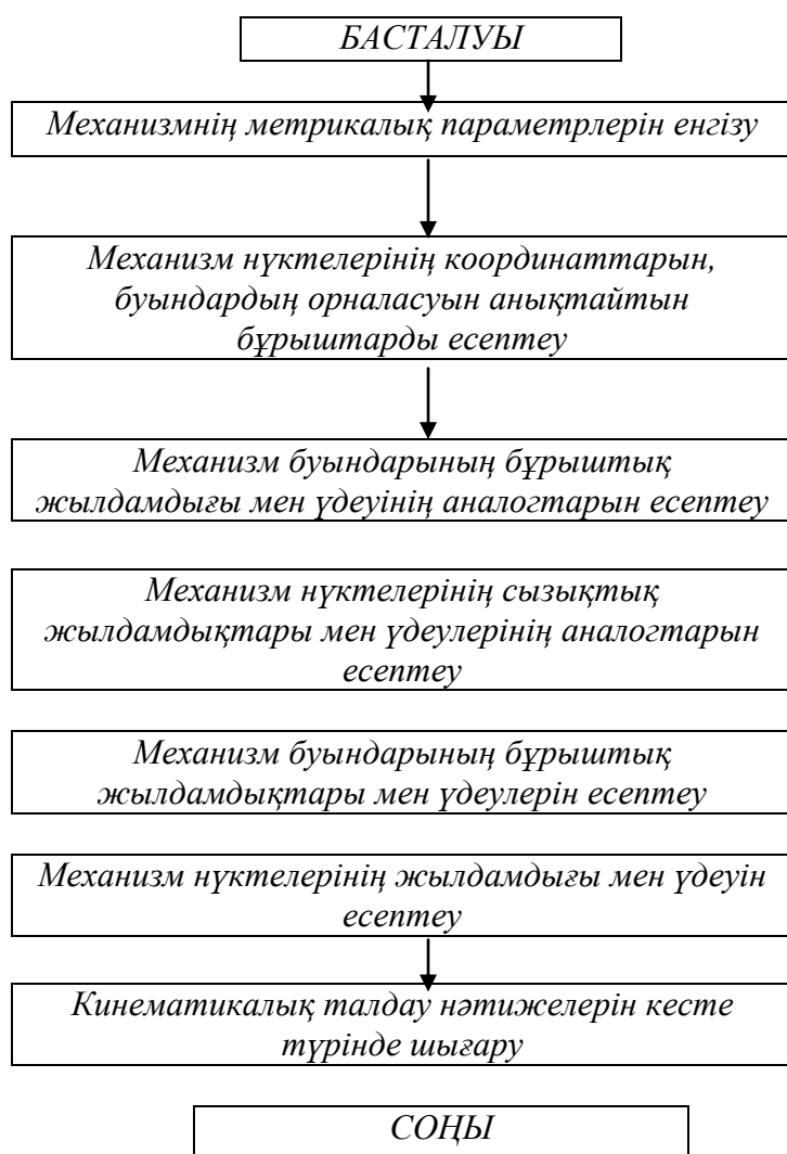
3.6-сурет. Бір шөмішті экскаватордың жұмыс жабдығы шөмішінің гидроиегінің ашу механизмін кинематикалық талдаудың блок-схемасы
